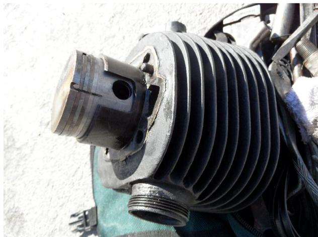
Abb.14: ein Kolbenklemmer von Michaels Bantam, doch Ersatzmotor mit dabei und schnell repariert.
